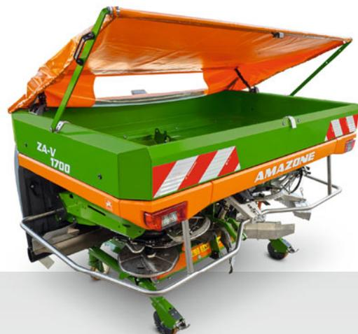
Bâche repliable avec arceau, en position de maintenance pour un nettoyage facile depuis l'intérieur
