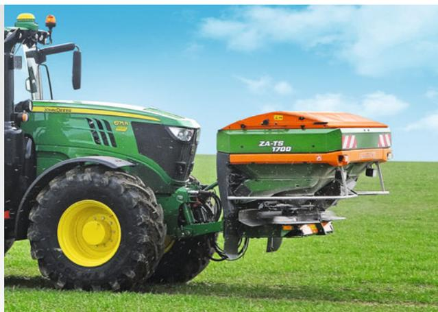
Epandeur porté frontal avec système d'éclairage adapté pour les déplacements routiers
