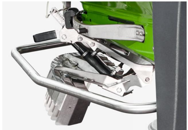
Systeme d'épandage hydraulique en bordure Limiter V
